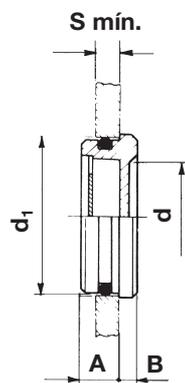
Para facilitar el montaje realizar un chaflán de 1 a 45° en el agujero y engrasar ligeramente la superficie exterior de la junta.
