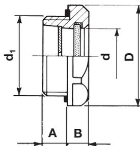
Para montar el visor y evitar su deformación elástica, se aconseja un par de apriete de  $5 \div 15$  Nm (según diámetro).
